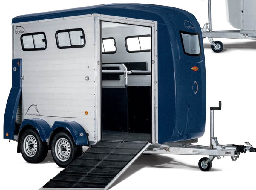
PORTAX K mit breiter und extra langer Entladeklappe vorne; mit Zubehör: Polyesterhaube und -bug in Dunkelblau-Metallic, je 2 seitliche Schiebefenster, Polyester-Einzelradkotflügel und Polyester- Seitenstrebenabdeckung
