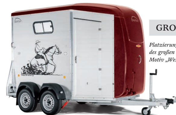
POLY.-HAUBE feuerrot (keine RAL-Farbe)** AUFBAU eloxiertes Aluminium DEKORFARBE anthrazit
